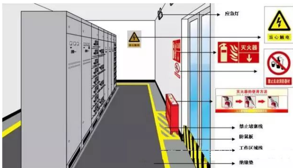
附配电间安全管理上墙看板
